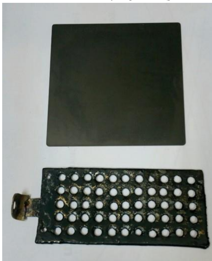
Рис. 1. Титановий анод, покритий оксидами рідкоземельних металів на підкладці з оксиду марганцю
