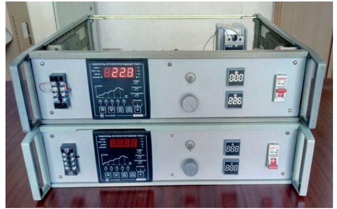
а б Рис. 6. Інформаційно-вимірювальна система 1246P-IBC (а) і системи вимірювання та регулювання температури АСВРТ (б)
