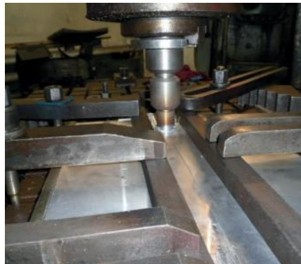
Рис. 18. Загальний вигляд процесу зварювання тертям з перемішуванням заготовок зі сплаву 2219
