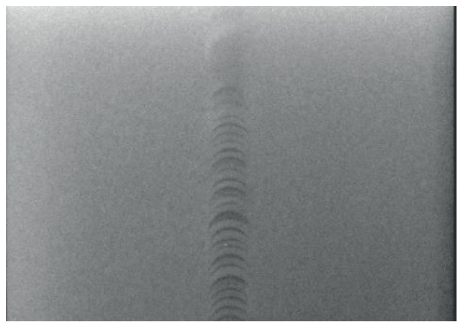
Рис. 20. Результати рентгенологічних досліджень якості зварних швів зразків плоских заготовок з алюмінієвого сплаву 2219, отриманих методом зварювання тертям з перемішуванням
