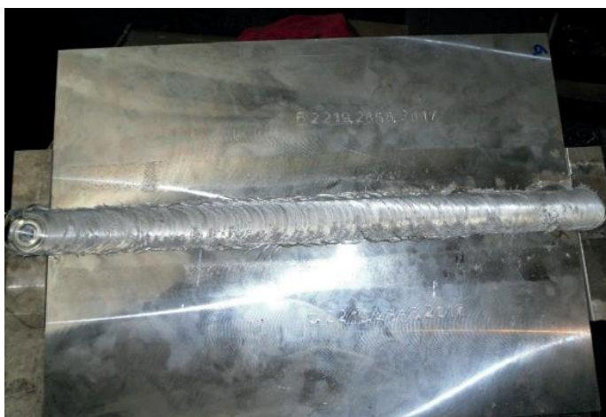
Рис. 19. Загальний вигляд зварених зразків плоских заготовок з алюмінієвого сплаву 2219 методом зварювання тертям з перемішуванням («лицьового» боку зварного з'єднання)
