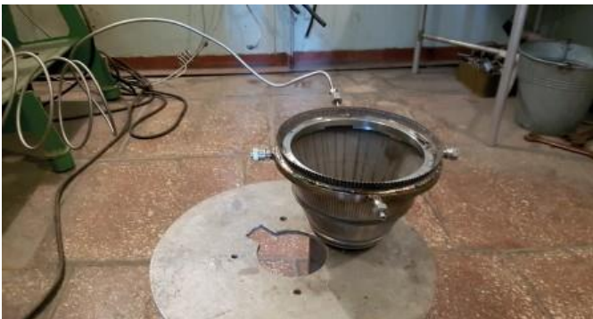
Рис. 5. Гідровипробування другого зразка малогабаритного соплового блока
