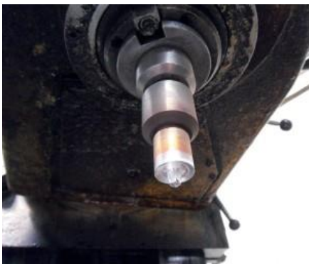
Рис. 18. Загальний вигляд процесу зварювання тертям з перемішуванням заготовок зі сплаву 2219
