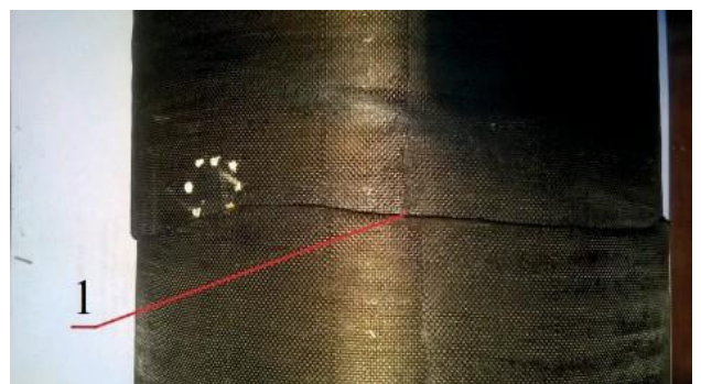
Рис. 14. Вигляд зони руйнування оболонки, випробуваної під час стискування за температури 300 °C
