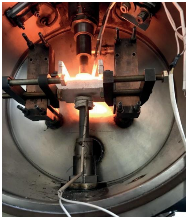
Рис. 2. Експериментальне обладнання для всебічного (а) й однобічного (б) нагрівання зразків
